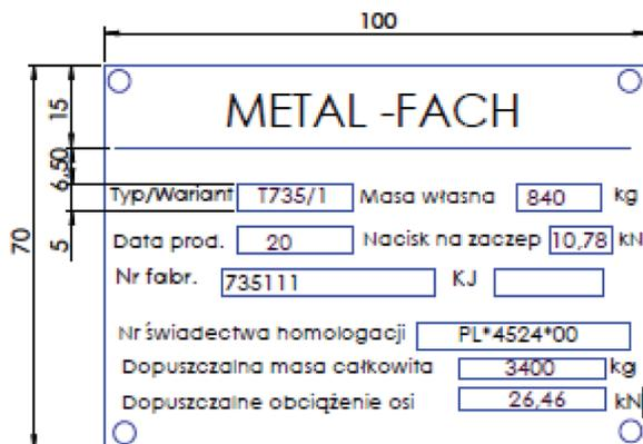
Идентификационные данные находятся на заводском щитке, расположенном на передней поперечной балке рамы кузова. Номер прицепа выбит на заводском щитке и под щитком.
