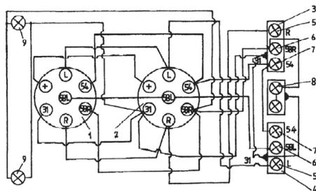
**Рис. 2** Схема электрической системы прицепа
