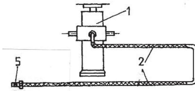
**Рис. 1** Схема гидравлической системы механизма опрокидывания грузового кузова
